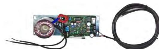
Scheda di comando con trasformatore 80VA-30V e cavo
