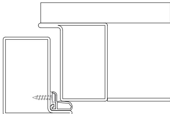
**IT** Guarnizione universale per porte blindate (battuta da 15 mm) composta da un profilo di alluminio ed una morbida guarnizione. Alte prestazioni di tenuta acustica e ottimo complemento per rispettare gli standard di certificazione CE del serramento.
